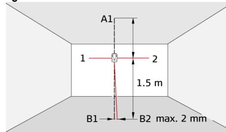
Drei instrumentet  $180^\circ$  slik at det er rettet i motsatt retning 2 av retning 1. Juster instrumentet slik at laserstrålen treffer punkt A1 nøyaktig. Hvis punkt B2 ikke er mer enn 2 mm unna punkt B1, ligger instrumentet innenfor toleranseområdet sitt.
