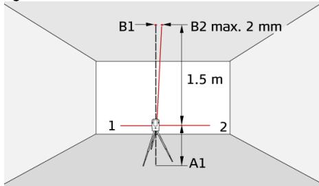
Sett låsbryteren i "ulåst" posisjon (se [Niv-elleringslås](#)). Still opp laseren på stativet på vegkonsollen nær punkt A1 i en minimums avstand på 1,5 m fra punkt B1. Den horisontale laseren er innrettet i retning 1. Merk laserpunktene A1 og B1 med en nål.
