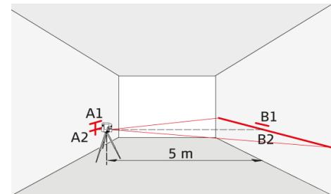
Plasser deretter instrumentet i samme høyde og så nær vegg A som mulig og merk igjen den horisontale laserlinjen på vegg A (A2). Dreй instrumentet 180° igjen og merk laseren på vegg B (B2). Mål avstanden mellom de merkede punktene A1-A2 og B1-B2. Beregn forskjellen mellom de to målingene.
