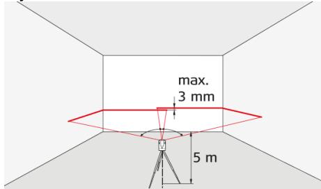
Sett låsbryteren i "ulåst" posisjon (se [Niv-elleringslås](#)). Plasser instrumentet ca. 5 m unna veggene. Rett instrumentet mot veggene og slå på instrumentet. Aktiver laserlinjen og merk av krysningspunktet til laserens trådkors på veggene. Drei instrumentet til høyre og deretter til venstre. Observer det vertikale avviket til den horisontale linjen fra merket. Hvis forskjellen ikke overskridet 3 mm, ligger instrumentet innenfor toleranseområdet.
