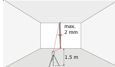
Sett låsbryteren i "ulåst" posisjon (se [Niv-elleringslås](#)). Bruk et snorlodd som referanse, plasser det så tett som mulig inntil en ca. 3 m høy vegg. Plasser instrumentet omtrent 1,5 m fra vegg i en høyde på ca. 1,5 m. Rett instrumentet mot veggene og slå på instrumentet. Drei instrumentet og rett det opp med bunnen av loddlinjen. Nå leser du av maksimalt avvik fra laserlinjen fra toppen av loddlinjen. Hvis forskjellen ikke overskridet 2 mm, ligger instrumentet innenfor toleranseområdet.
