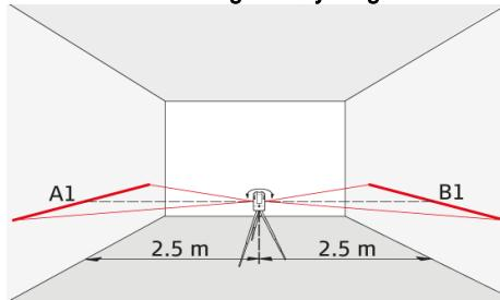
Still instrumentet på et stativ halvveis mellom to vegg (A+B) som står ca. 5 m fra hverandre. Sett låsbryteren i "ulåst" posisjon (se [Nivelleringslåsen](#)). Rett instrumentet mot vegg A og slå på instrumentet. Aktiver den horisontale laserlinjen eller laserpunktet og merk linjens posisjon eller punktet på veggen (A1). Dreй instrumentet 180° og merk den horisontale laserlinjen eller laserpunktet på nøyaktig samme måte på veggen (B1).
