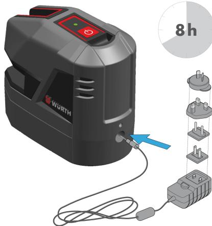
Lad opp Li-ion batteriet før du bruker det for første gang. Instrumentet kan bli varmt under lading. Dette er normalt, og det skal ikke påvirke instrumentets levetid eller ytelse. Ved den anbefalt oppbevaringstemperaturen på -20 °C til +30 °C (-4 °F til +86 °F), kan batterier som er oppladet fra 50 % til 100 % kapasitet oppbevares i opp til ett år. Etter utløpet av denne lagringsperioden må batteriene lades opp på nytt.
