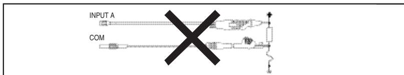
(Ukorrekt jording) Bakgrunnsstøy på grunn av uskjermet jordingsledning
